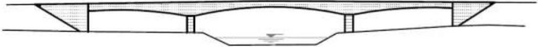
Slika 9.2.10: Gredni rečni mostovi promenljive visine
