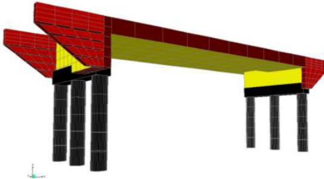
Slika 15: 3D model integralnog mosta
